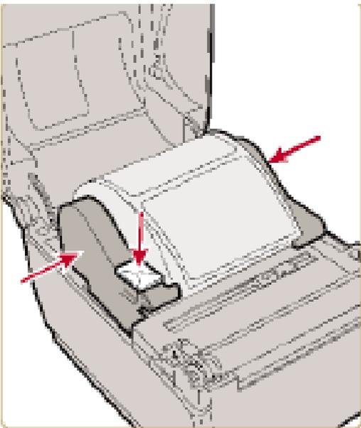
c. Assurez-vous que les porte-supports sont bien ajustés latéralement contre le rouleau de support et appuyez sur la languette pour les sécuriser.
