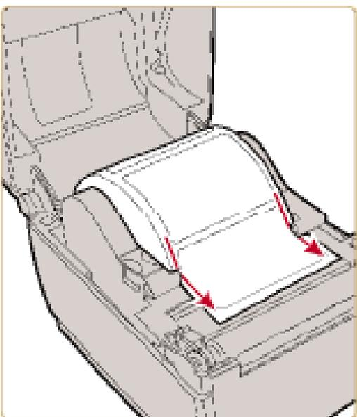
4. Faites passer le support sous les guides de chaque côté des porte-supports et au-delà de l'avant de l'imprimante.
