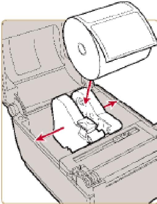
b. Faites glisser les porte-supports pour régler la distance qui les sépare, et insérez le rouleau entre les porte-supports.
